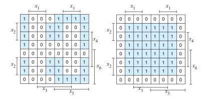
Beachten Sie, dass in KV-Diagrammen mit fünf oder mehr Variablen benachbarte Variablenbelegungen nicht mehr in jedem Fall nebeneinander angeordnet sind und Blöcke dadurch aus verschiedenen Fragmenten zusammengesetzt sein können.
